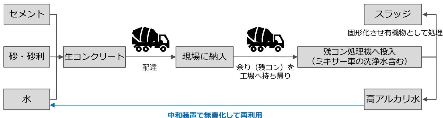
生コン工場における水処理の流れ
