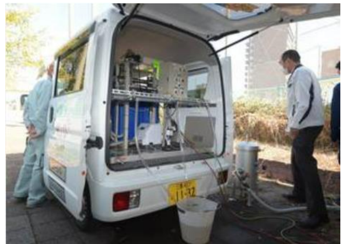
「深紫外線」を応用し、プールの水を飲用にできるろ過装置
