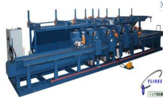
【曲げ機（鉄筋の曲げと切断を行うために使用）】
