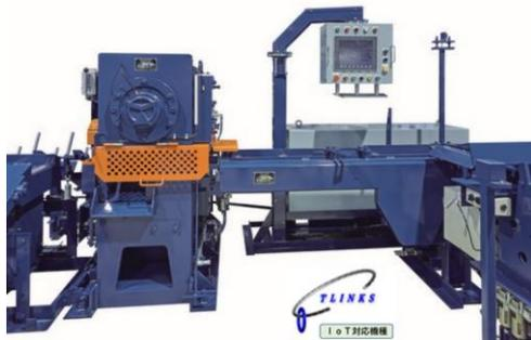
【切断機（口径の太い鉄筋を切断するために使用）】
