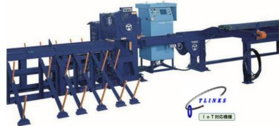
【曲げ機（口径の太い鉄筋を曲げるために使用）】
